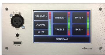
Die externe Steuerung 305TFT dient zur Ansteuerung von einem externen Lautsprecherbereich. Die Lautstärke-, Höhen- und Tiefeneinstellung erfolgt über den Touchscreen. Die zwei Eingänge, MIC (symmetrisch) und AUX (asymmetrisch), können gemischt werden und als Programm in die externe Steuerung 305TFT eingespeist werden. Weiters verfügt die externe Steuerung 305TFT über einen MP3-Player.
