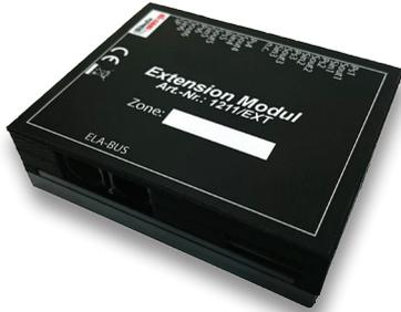
Mit dem Extension Modul kann das PROMAS System sehr einfach und günstig um 6 Rufbereiche erweitert werden. Das Modul verfügt über 6 Relais welche einzeln via ELA-BUS angesteuert werden können. Neben dem Lautsprechersignal gibt das Modul auch eine entsprechende Vorrangspannung aus. Mit dieser Vorrangspannung kann der Vorrang von externen Steuerungen aktiviert werden. Mittels Codier Schalter kann das Extension Modul adressiert werden.
