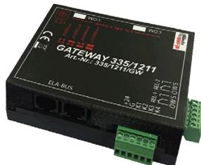
Das Gateway verfügt über 2 RS232 Ausgänge und über zwei Schaltkontakte. Das Gateway wird mittels ELA-BUS mit der Touchsteuerung verbunden. (max 1.100m). Es können bis zu 9 Gateways an einem Bus verwendet werden. Die Einstellung der Adresse und der Baudrate erfolgt direkt am Gateway.
