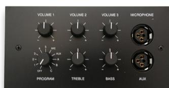
Der Regler 306 dient zur Ansteuerung von drei externen Lautsprecherbereichen. Die Lautstärke-, Höhen- und Tiefeneinstellung erfolgt über stufenlos regelbare Drehpotentiometer. Die zwei getrennten XLR-Eingänge MIC (symmetrisch) und AUX (asymmetrisch) werden als Programm in die externe Steuereinheit eingespielt. Mit dem Drehschalter können 5 Programme, MIC, AUX und weiter drei Eingänge (A, B, C) selektiert werden.
