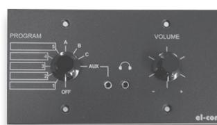
Die externe Steuereinheit 304-V2 dient zur Ansteuerung von einem externen Lautsprecherkreis. Die Lautstärkeeinstellung und die Programmwahl erfolgen mittels Drehschalter. An dem AUX-Eingang kann eine Signalquelle mit einem 0dB-Ausgang angeschlossen werden.
