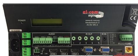
Der MediaSwitch-3 Compact enthält alle Komponenten die für eine professionelle Mediensteuerung benötigt werden. Alle Komponenten sind in einem kompakten Gehäuse untergebracht. Es gibt keine dezentralen Artikel die in Wänden, unter Tischen oder Zwischendecken verbaut werden müssen. Alle benötigten Kabel werden zum MediaSwitch-3 Compact geführt.
