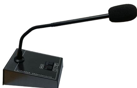
Mit dieser Sprechstelle kann in einem zuvor codierten Lautsprecherbereich, durch Betätigen der RUF Taste, eine Durchsage gemacht werden. Bei Betätigung der ALARM-RUF Taste ist die Durchsage in allen Lautsprecherbereichen zu hören (Generalruf). Ansagen vom Alarmspeichermodul werden bei einer Durchsage mittels ALARM-RUF Taste unterbrochen.
